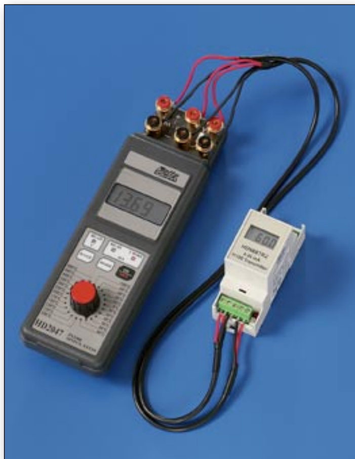
Fig. 3 Verificación de un transmisor pasivo con ingreso Pt100
